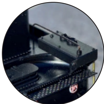
Réservoir à T.I.A sur le tender
