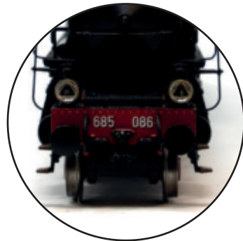
Fanali a petrolio funzionanti e respingenti moderni
