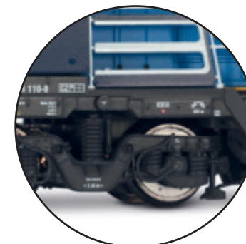
Carrelli di precisione con dischi freno in metallo
