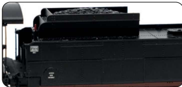
Tender con sopralzo carboniera e chiodature aggiuntive
