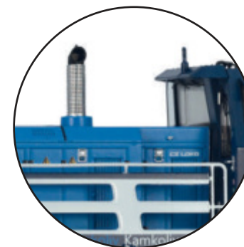
Rivestimento del tubo di scarico realizzati in fotoincisione
