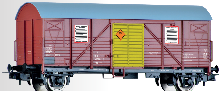
Gedeckter Güterwagen Glms 1364 der DR für den Transport von Tetraethylblei Open car Glms 1364 of the DR for the transport of tetraethyl lead
